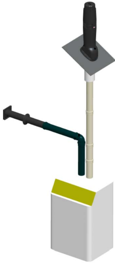
Figure 11 – Schéma de principe du système ROLUX CONDENSATION en configuration C 5 séparée verticale (selon les conditions des tableaux 1 et 2)
